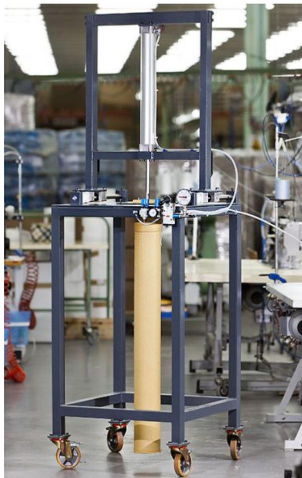
Установка для испытаний узла пластины с отверстием
