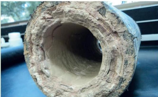
Кальцитовая накипь с твердыми включениями в хвостопроводе.
